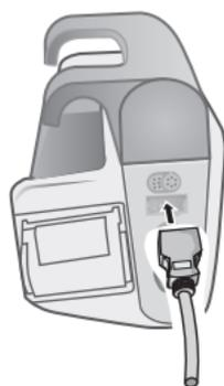
Connexion d'une sonde SpO<sub>2</sub>
