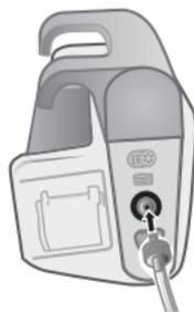
Raccordement d'un tuyau à double lumière
